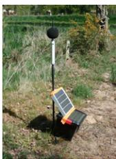
Suite à la mise en service du parc éolien, une nouvelle étude acoustique sera réalisée afin de vérifier sa conformité avec la réglementation.
